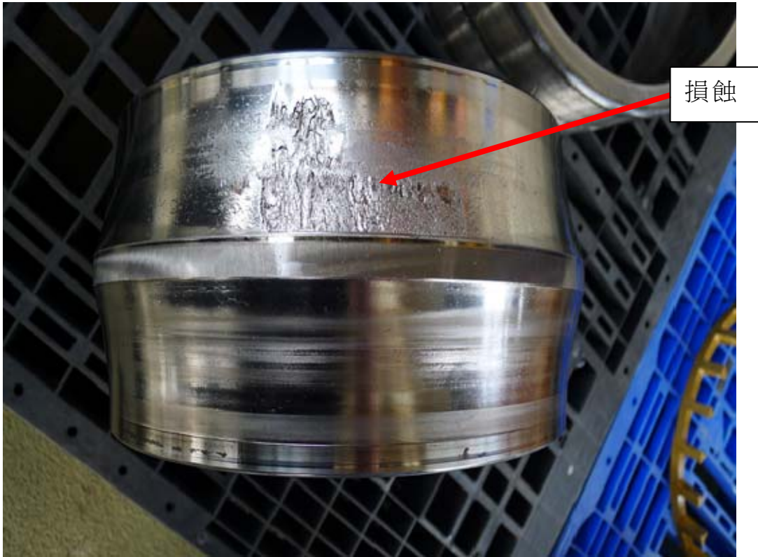
圖 5：上軸承內環的頂端滾道之損蝕
