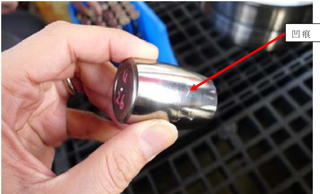
圖 7：上軸承的頂部滾柱的凹痕
