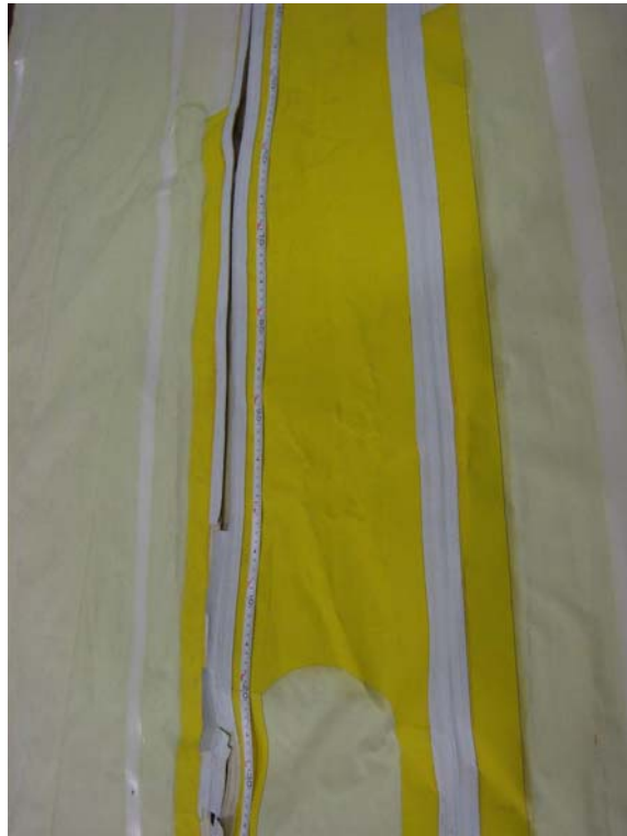
圖 4 - 右邊接縫位置受損 (由氣囊內部檢視，因此呈相反方向)
