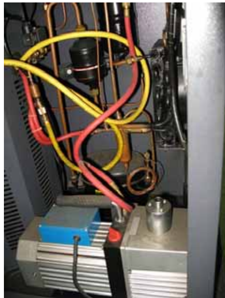
雪種補充/ 回收/ 更換機內的壓縮泵
