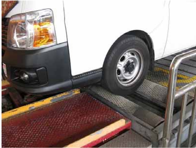
接受檢驗車輛的同一車軸上的兩個車輪停在滾輪上
