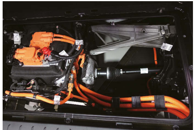
不論電動車或混能車，車內的橙色線都帶有高壓電源，除非受過專門訓練，否則不應自行拆卸
