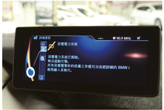
切斷電源後，車內的確認顯示
