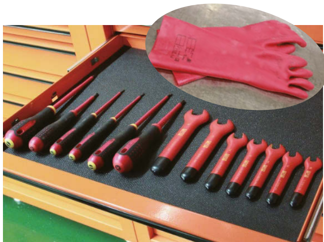
使用絕緣手套及絕緣工具進行維修，以策安全
