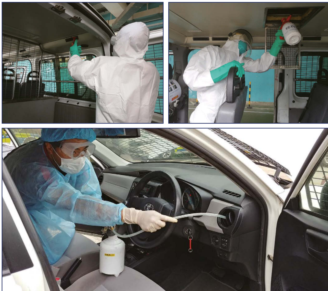
使用1:49稀釋家用漂白水噴灑冷凝器及各出風口等位置
