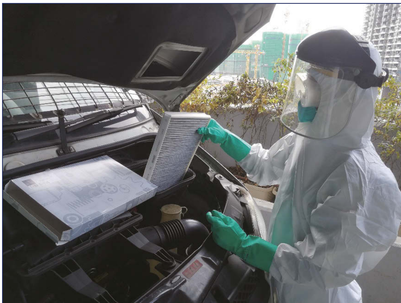
定期更換冷氣回風口的過濾網
