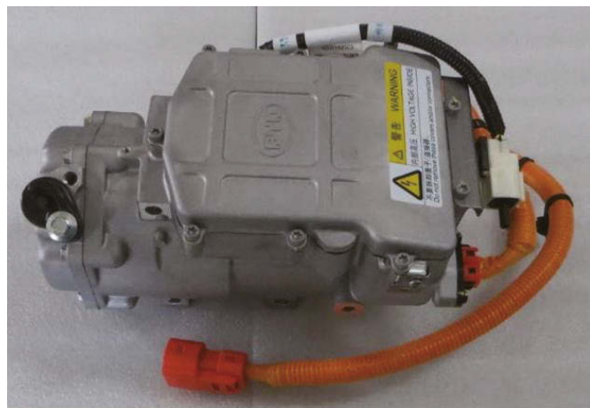
高壓電動冷氣壓縮機（圖1）
