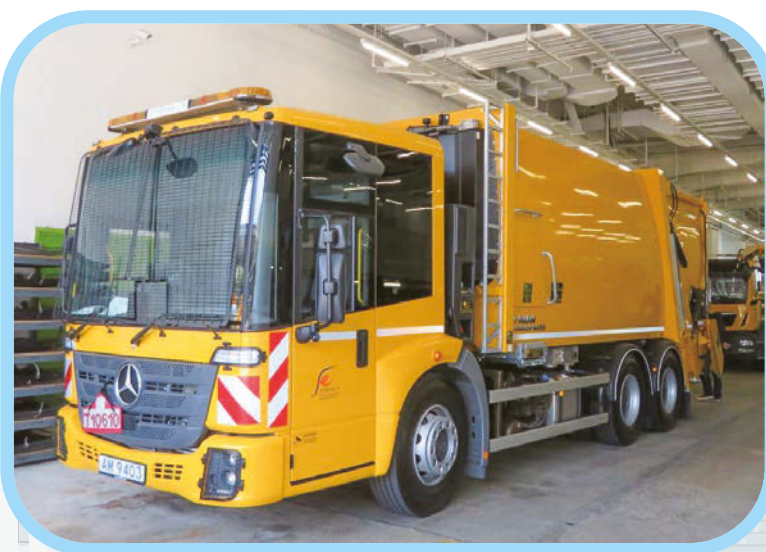
食環署於 2019 年購置的首批低地台垃圾收集車 (採用平治 Econic 底盤及 FAUN Variopress 垃圾收集斗)
