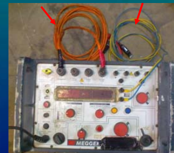
模擬變流器次級輸出之電源線 記錄觸發跳脫時間之訊號線
