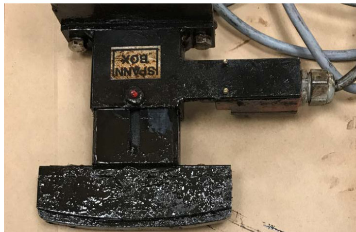
圖 9：BCD 可移動部件及導軌的相片。在 BCD 表面發現由用以潤滑主驅動鏈的潤滑油與塵埃混合而成的黏性油脂。
