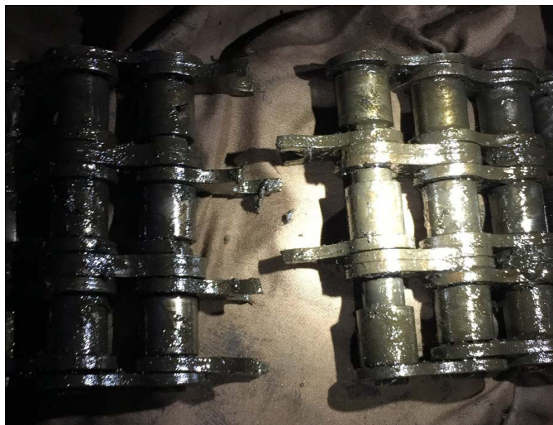
圖 4：顯示主驅動鏈斷裂位置的相片
