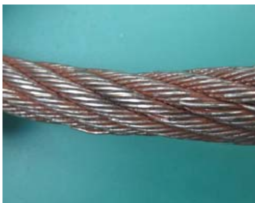
圖 4：纜索外面已磨損（纜面磨損），纜股間的股坑有紅色氧化鐵粉（銹粉）。
