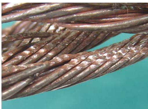
圖 3a：懸吊纜索斷口近觀。只留有內部鋼絲和主鋼絲。
