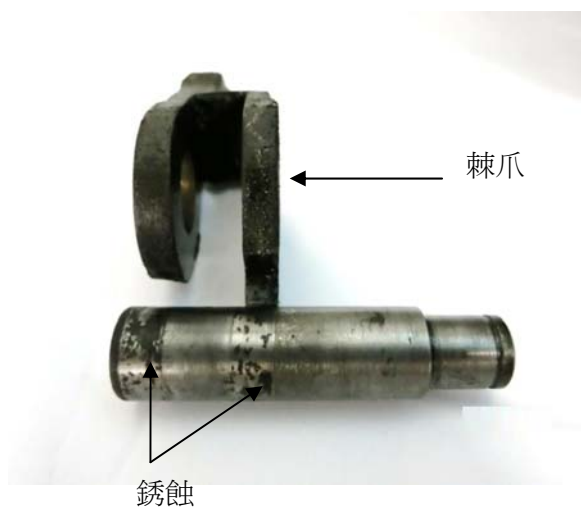
圖 13：限速器棘爪的轉軸。
