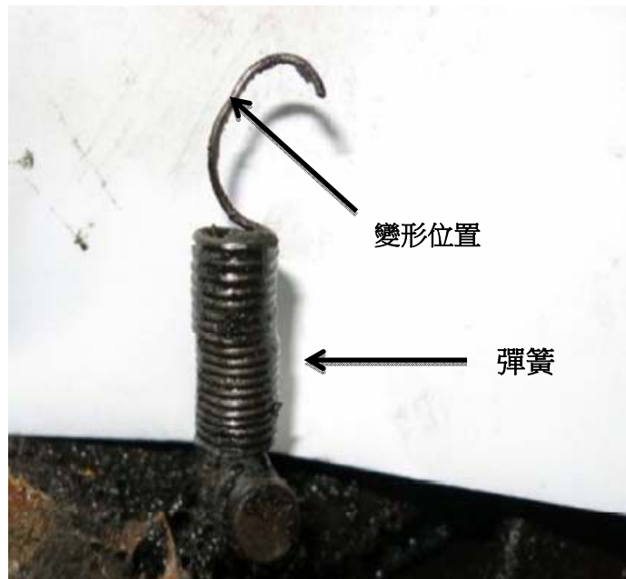
圖 12：照片顯示彈簧的尾端已變形。
