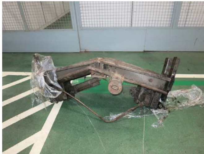
圖 7：已變形的機廂底架外觀
