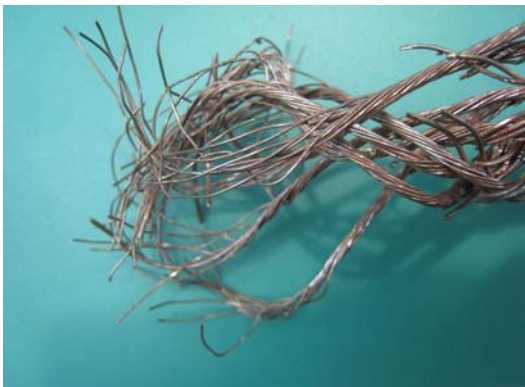
圖 3a：懸吊纜索斷口近觀。只留有內部鋼絲和主鋼絲。
