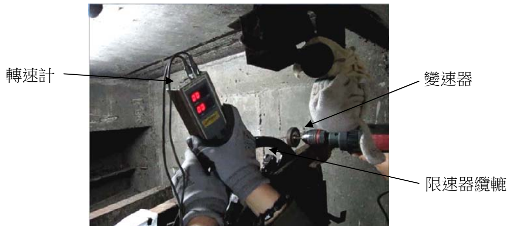
圖 9：限速器啟動速度測試安排—利用變速器驅動限速器纜轆。
