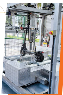
電動可移動工具速度綜合測試儀測試電動滑板車的運作 The EMD Speed Tester tests the operation of an electric scooter
