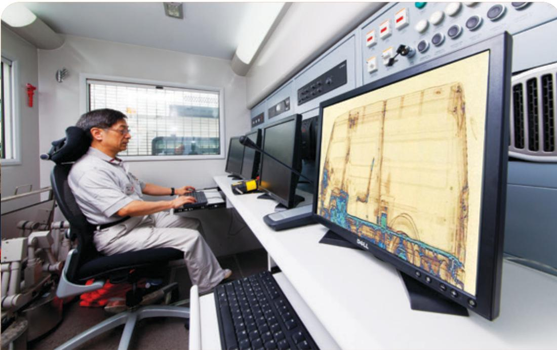
營運基金工程師正在測試用作監控掃描過程和實時檢視掃描影像的精密儀器。彩色 X 光影像可清楚顯示被掃描車輛內的不同物料。
