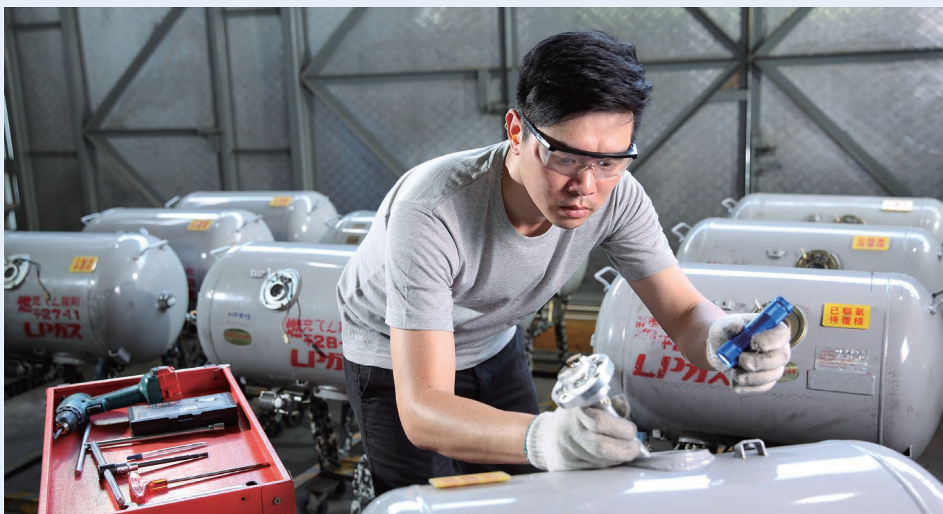
技術人員檢測車用石油氣燃料缸，以滿足有關覆檢的法例要求。 Technician examines an auto-LPG cylinder to comply with statutory testing and revalidation requirements.
