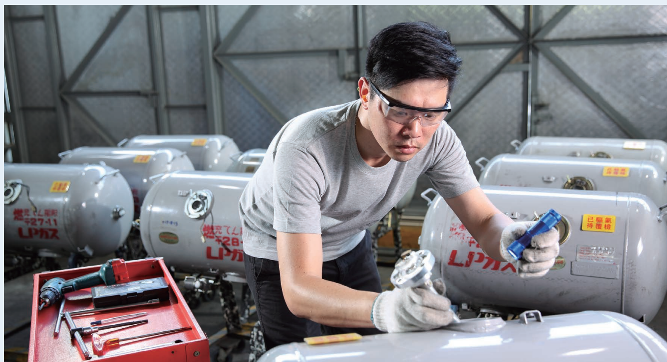
技術人員檢測車用石油氣燃料缸，以滿足有關覆檢的法例要求。
