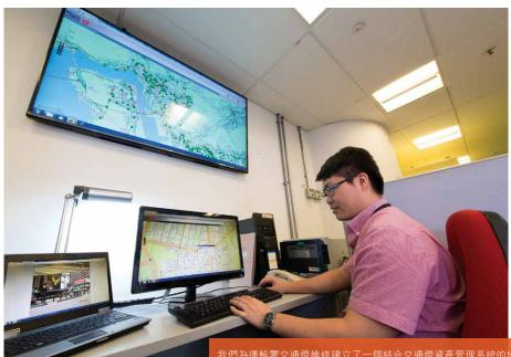
我們為運輸署交通燈維修建立了一個結合交通燈資產管理系統的地理資訊平台,系統已於2014年11月投入服務, 能實時監察 1,800 個路口的交通燈。
