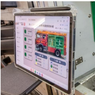
機電署與消防處共同研發的資產管理系統，運用5G和無線射頻識別技術，實時監察消防車上救火工具和救援設備的可用情況、狀態和存放位置，有助有效管理大量不同類型的資產，以及提高消防員的職業安全 and 健康水平。
