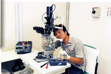
技術員為博愛醫院的眼科激光機及裂隙燈進行維修。
