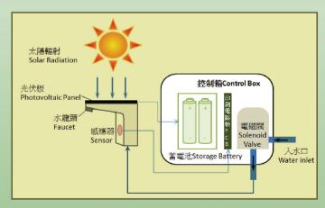
太陽能節水水龍頭的運作原理。由太陽光產生的電力可儲存於電池內,為水龍 頭供電。
