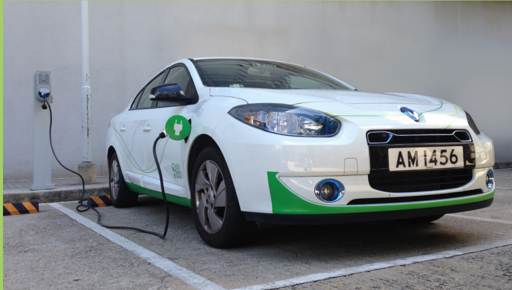
香港大部分電動車都可以支援IEC 61851標準的傳導充電模式3充電。 IEC 61851 Mode 3 conductive charging is supported by most electric vehicles in Hong Kong.
