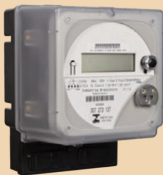
智能電錶的外貌跟舊式的電錶相似，但內置智能及溝通模式。
