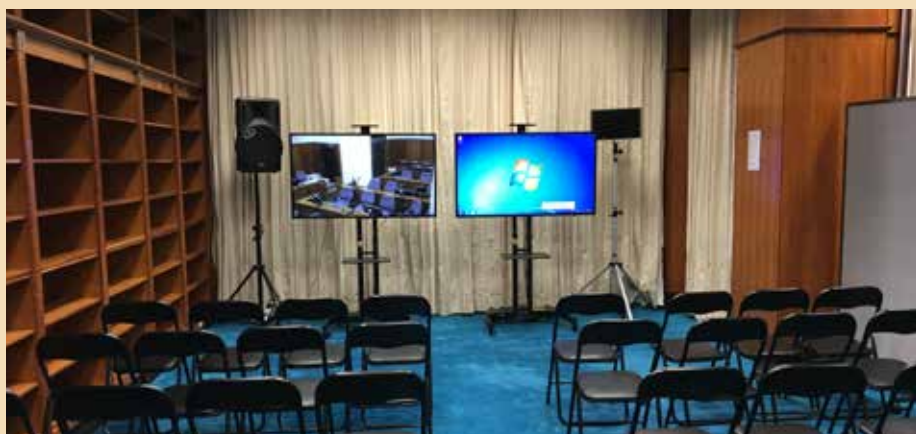
在食水含鉛超標調查委員會公眾聆訊裏，我們設立的視聽轉播系統接收聆訊室的視聽訊號，而證物伺服器則把聲音和視像傳送到聆訊轉播室內。
