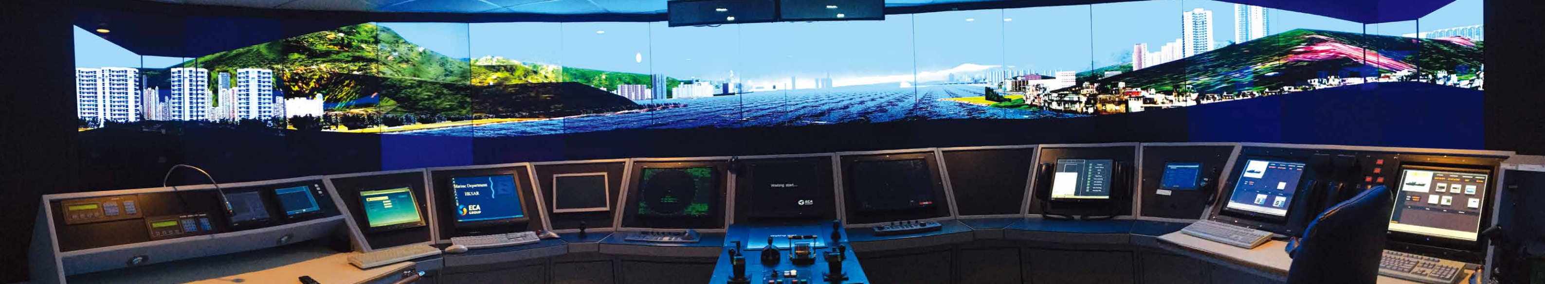
二號訓練駕駛台：由15台高清液晶顯示屏組成接合外景影像的船舶模擬器，提升海洋環境的仿真度，讓受訓者更有效學習。
