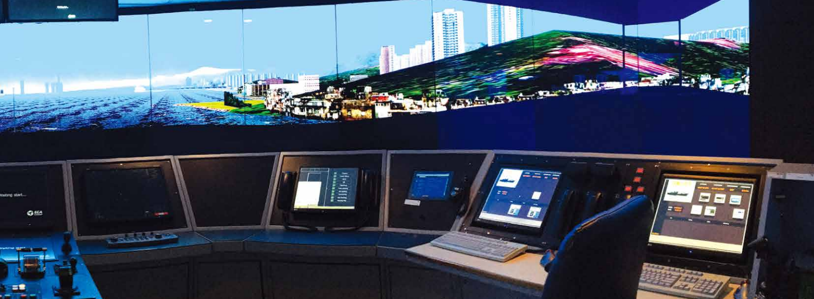
二號訓練駕駛台：由15台高清液晶顯示屏組成接合外景影像的船舶模擬器，提升海洋環境的仿真度，讓受訓者更有效學習。
